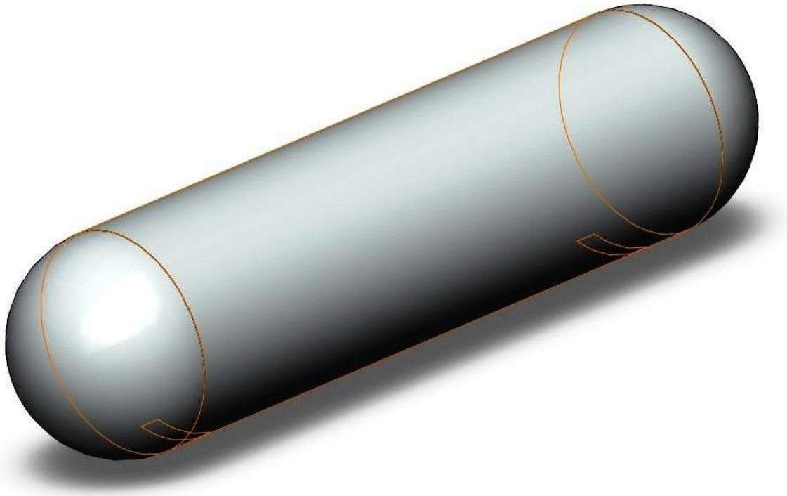
Рисунок 1– Розрахункова комп'ютерна модель котла вагона-цистерни
